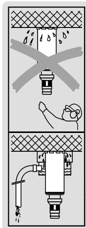
Para trabajos en techos es obligatorio utilizar el sistema colector de agua con un aspirador en húmedo.
