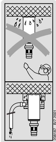
Para trabajar en techos es obligatorio utilizar el sistema colector de agua en combinación con un aspirador en húmedo. Ponga el mango lateral y el cabezal de inyección/aspiración de agua en una posición que no estorbe el montaje del sistema colector de agua. El casquillo de perforación y la junta hermética tienen que estar adaptados al diámetro de la corona de diamante.
