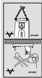
¡No se permite perforar a altura por encima de la cabeza sólo con fijación de vacío!
